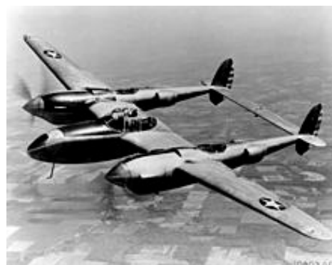
Lockheed P-38 „Lighting“, motory 1150 - 1450ks rychlost 630, později 660km/hod, kanon1x20mm 4 kulometry 12,7mm, dolet 4250km, od r.1941
