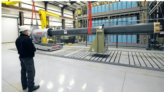
Technik řídí jeřáb při usazování hlavně elektromagnetického děla
